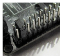
< Jumper in Betriebs-Position
